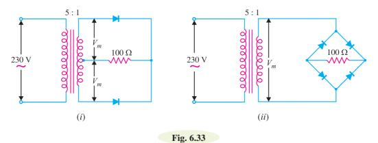
Solution. (*i*) D.C. output voltage *Centre-tap circuit*
